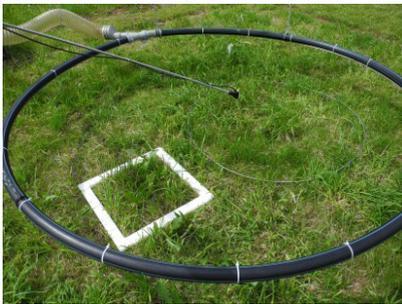
**Begasungseinheit mit Erntering sowie Teflonrahmen zum Fixieren von mobilen Gaswechselkammern**
