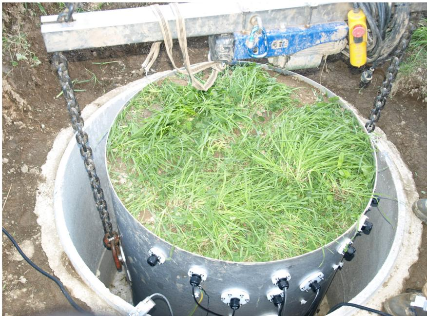
Abbildung 1: Lysimeter mit Sondenausstattung vor dem Einbau
