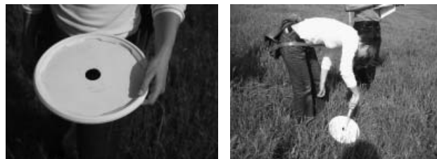
Abbildung 2: Messung der Aufwuchshöhe mit Hilfe der Deckelmethode
