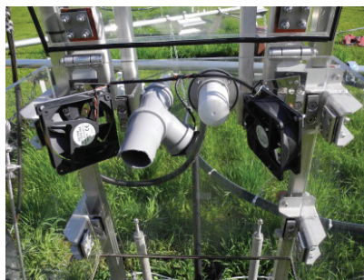
Vollautomatisierte Einheit zur Messung des Gaswechsels im Pflanzenbestand
