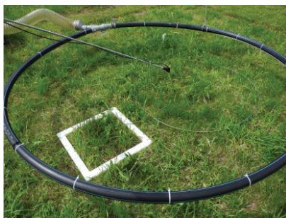
Begasungseinheit mit Erntering sowie Teflonrahmen zum Fixieren von mobilen Gaswechselkammern
