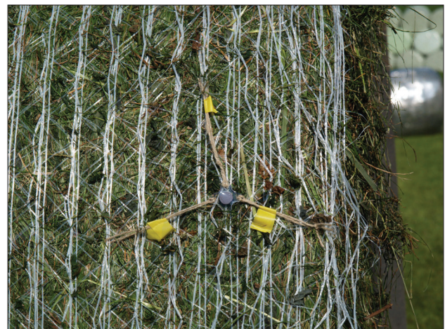
Abbildung 1: Montierter Spotsticker-Sensor (grauer Kreis).
