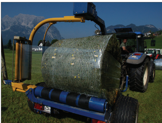
Abbildung 3: Wicklung Messballen mit Agristretch Crystal.
