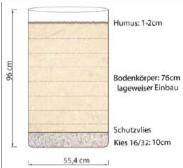
Abbildung 1: Dimensionen der Versuchsbehälter und Aufbau des Bodens.
