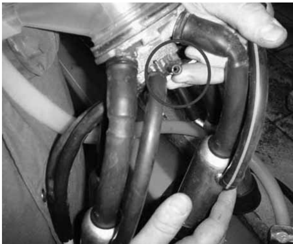
Einbau einer Drossel im Luftverteiler
