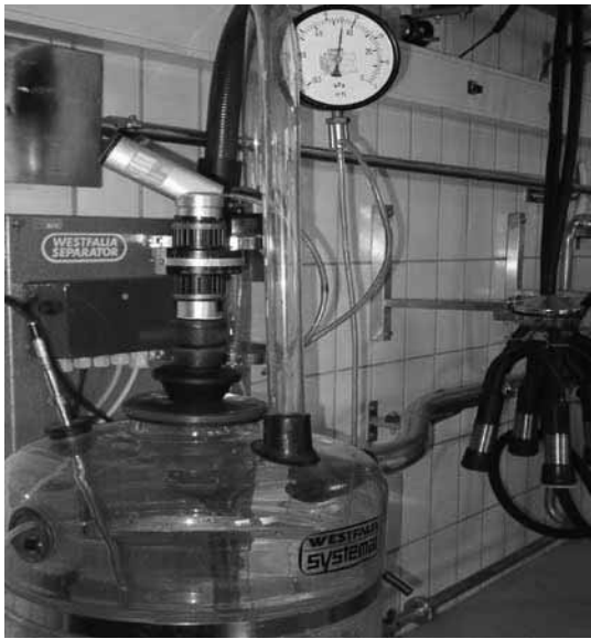
Abbildung 7: Mindest-Reservedurchfluss bei Rohrmelkanlagen
