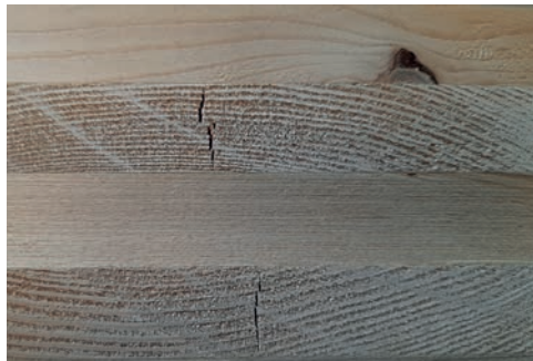
Abbildung 1: Kreuzweise verklebter Aufbau von Brettsperrholz (© Holzplus GmbH)
