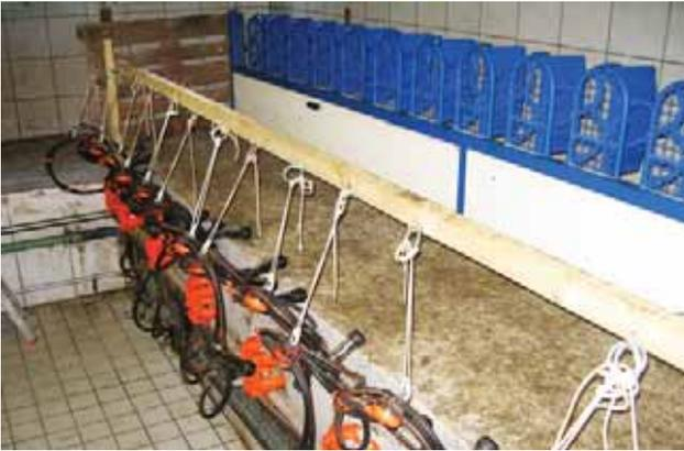
**Foto 2: Der Auto 3er Tandem Melkstand wurde in einen einreihigen 16er Side-by-Side Melkstand umgebaut**
