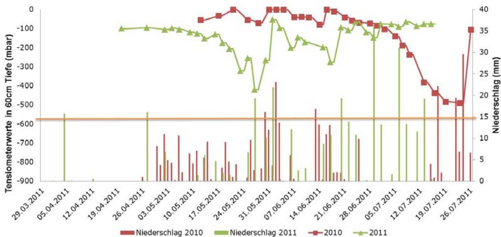
Abbildung 3: Tensiometerwerte in 60 cm Bodentiefe in den Jahren 2009 bis 2011 in der Kontrolle und Niederschläge während der Vegetationsperiode Figure 3: Data of tensiometers in 60 cm soil depth in 2009, 2010 and 2011 in the the control environment, and precipitation during the growing period
