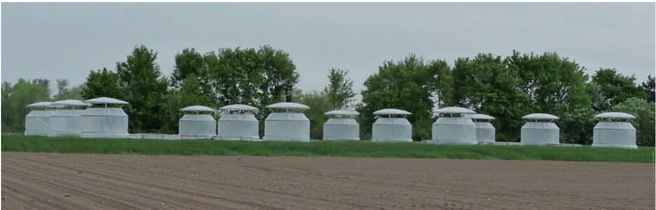
Abbildung 2: Zwölf open-top Kammern inmitten der Mantelsaat. Sechs der Kammern wurden mit Außenluft (~390 ppm CO 2 ), die übrigen sechs mit Außenluft plus zusätzlichem CO 2 (~700 ppm CO 2 ) belüftet.
