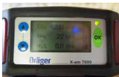
Abbildung 7: Mobiles Messgerät zur Überprüfung der Schadgasgehalte
