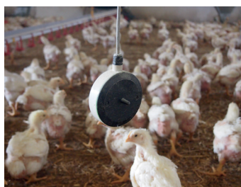
Abbildung 4: Regelmäßiger Abgleich der Sensoren erforderlich
