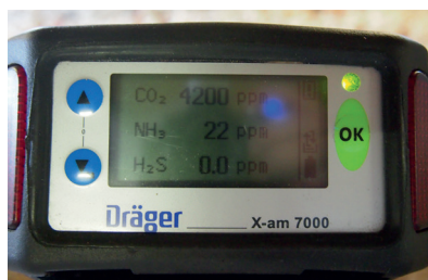
Abbildung 7: Mobiles Messgerät zur Überprüfung der Schadgasgehalte
