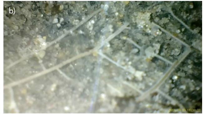
Abbildung 4: Wurzelbeobachtungen am 23.09.2020 im Schwammstadtsubstrat in Lysimeter 4 in einer Tiefe von ca. 50 cm – a) in 70 cm Entfernung, und b) 150 cm Entfernung vom Baum.
