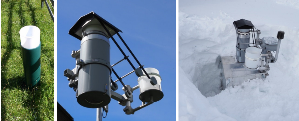
Abbildung 2: RS200 Bulk-Sammler und Wet-And Dry-only-Sammler zur Erfassung von Gesamtdeposition und nasser Deposition.
