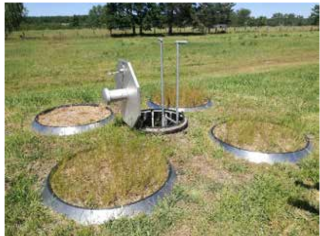
Abbildung 2: Ansicht der Lysimeteranlage Grünewalde (Foto: Carina Schuhmann 01.06.2017).
