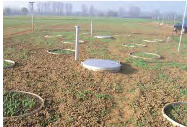
Abbildung 1: Blick auf die Ackerland-Lysimeter am Standort Selhausen
