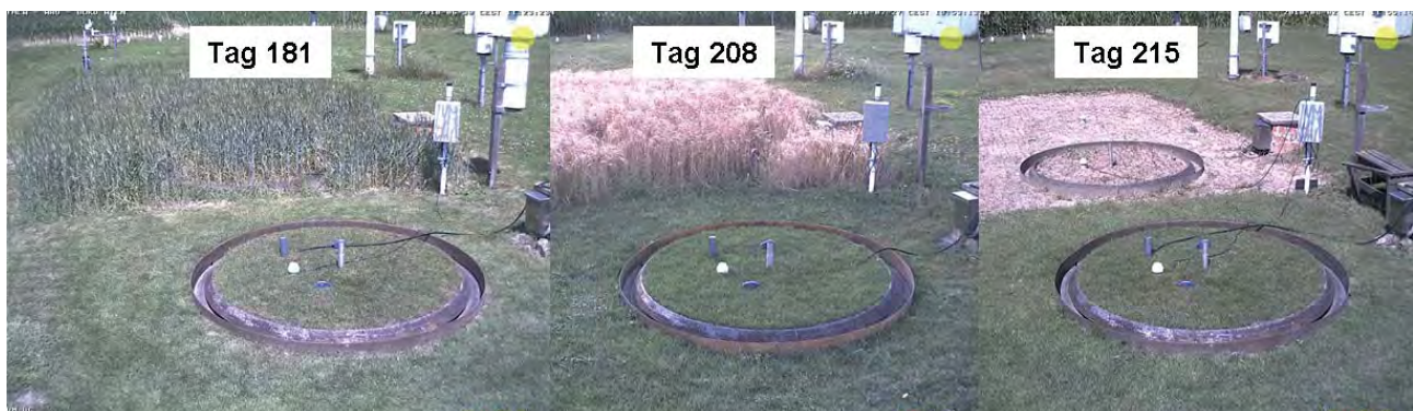
Abbildung 1: Die Verdunstung von beiden Lysimetern wurde im Zeitraum vor (Tag 181 bis 208) und nach (Tag 209 bis 235) der Ernte von Durumweizen am 28.7.2010 (Tag 208) ermittelt
