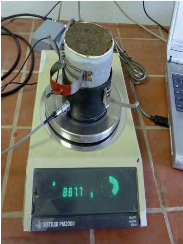
Abbildung 2: HYPROP System gekoppelt mit dem Umfangsmeter
