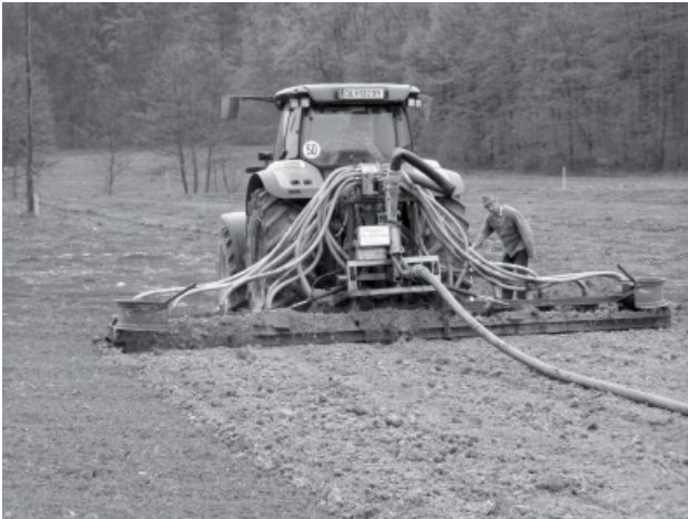
Abbildung 2: Gülleinjektor mit Gülleverschlachtung
