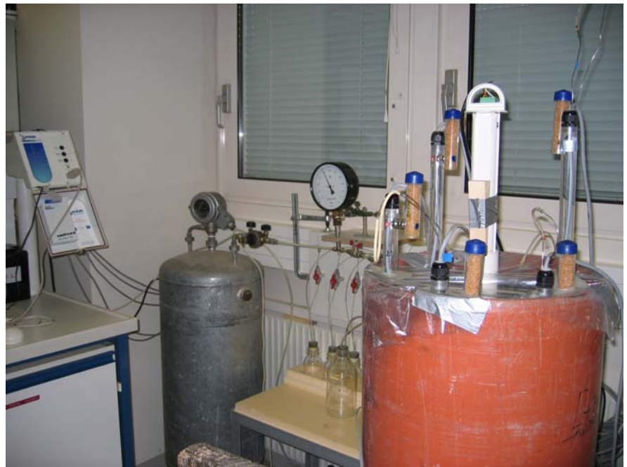
Abbildung 1: Versuchsausrüstung (Bodensäule, Tensiometerschäfte, Trägerplatine für die FDR-Sonde, Aufzeichnungsmodul, Unterdruck-Kessel und einzelne Saugflaschen)
