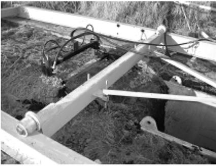
Abbildung 1: Horizontale monolithische Befüllung des Lysimetergefäßes
