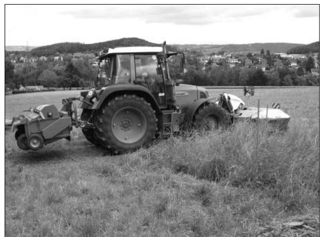
**Abbildung 2: Verwendeter Traktor mit Trommelmähwerk (CLAAS corto 3150F, Mähbreite 3 m) und hinten montiertem Aufbereiter (Kurmann K618).**
