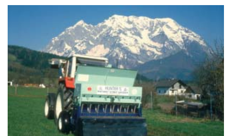
Abbildung 5: Bandfräse Hunter (Strip seeder) im Einsatz – 8 cm breite Bänder werden im Abstand von 22,5 cm herausgefäst und das Erdepflanzengemisch gleichmäßig auf der Fläche verteilt
