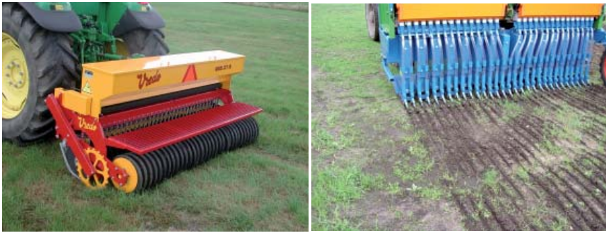
Abbildung 4: Vredo und Kockerling Schlitzdrillmaschinen im Einsatz
