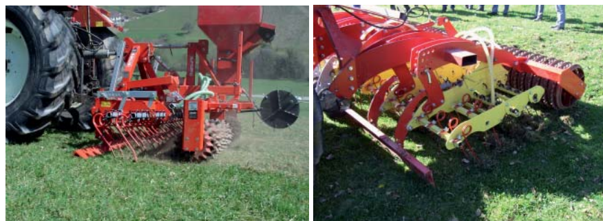
Abbildung 3: Wiesenstriegel von Güttler (li) und APV (re) mit den stärkeren Zinken, geeignet auch zum Durchlüften verfilzter Bestände
