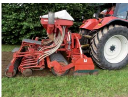
Abbildung 6: Kreiselegge mit Packer-ringwalzen, pneumatisches Säsystem, Scheibensächaren und Gummiwalze
