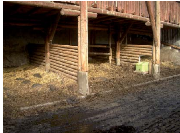
Abbildung 1: Tretmistsystem Mutterkuhhaltung, Anfall von Festmist sowie Jauche im Fressbereich. Bild: Angeringer
