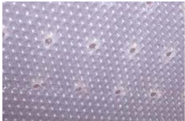
Abbildung 6: Doppellagige Kunststofffolie als Zuluftelement
