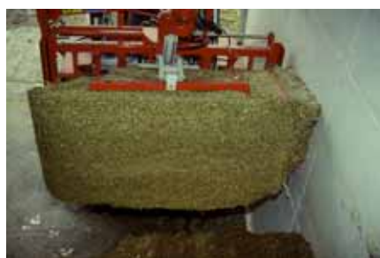
Foto 2: Siloblockschneider sind nach wie vor für die Entnahme und Vorlage für kleinere bis mittlere Herdengrößen eine kostengünstige Alternative. Ränder werden sauber mitgenommen.
