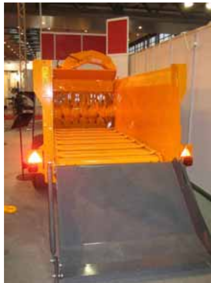
Foto 3: Verteilwagen mit Kratzboden. Auflösewalze und Gebläse eignen sich für große Mastställe für die Futtermittelverteilung und die Einstreuverteilung.
