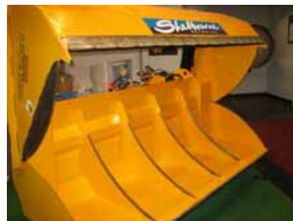
Foto 1: Geschlossene Schneidschaukeln eignen sich auch für die Entnahme und den Transport von Maissilage. Die Entnahmezeiten sind sehr kurz (5-10 sec).
