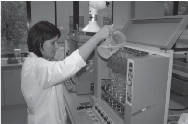
Abbildung 3: Nasschemische Analyse der Gerüstsubstanzen (Futtermittellabor Rosenau)
