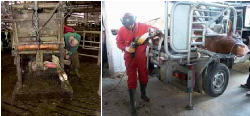
Abbildung 4: Wo macht die Klauenpflege mehr Spaß? In gebückter Haltung am hydraulisch unterstützten Durchtreibbestand aus DDR-Zeiten oder aufrecht stehend am hydraulischen Klauenpflegestand, hier: Modell Rosensteiner
