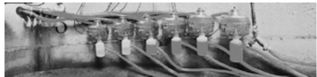
Abbildung 5: Wippen mit Probennahme Flaschen für die Erfassung von Sickerwasser.
