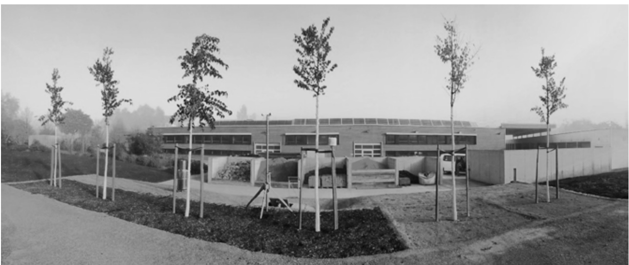
Abbildung 2: Ansicht der Lysimeteranlage mit der Baumart Celtis Australis , aufgenommen am 06.11.2015 (die linken 4 Zürgelbäume stehen im nicht überbaubaren Substrat mit Rindenmulch Abdeckung und die beiden rechten Bäume im überbaubaren Substrat mit wassergebundener Decke).
