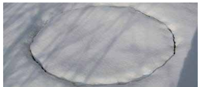
Abbildung 4: Lysimeteroberfläche nach erfolgter Trennung der Schneeauflast.
