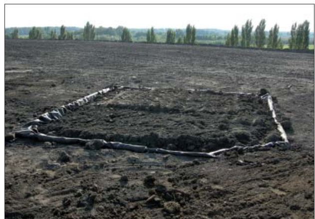
Abbildung 3: Blick auf die Lysimeteroberfläche nach dem Einbau
