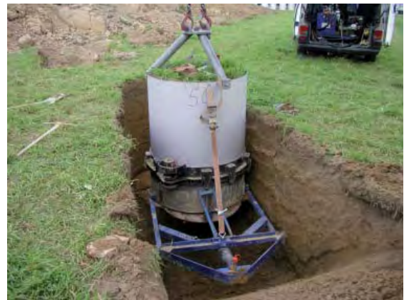
Abbildung 2: Abschervorrichtung für Bodenmonolithe.
