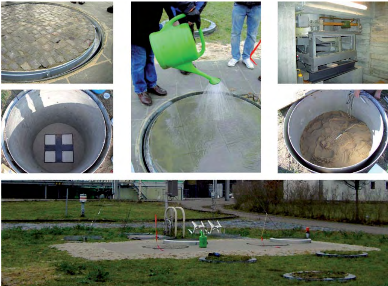
Abbildung 5: Unterschiedliche Aspekte der teilversiegelten Lysimeteranlagen.
