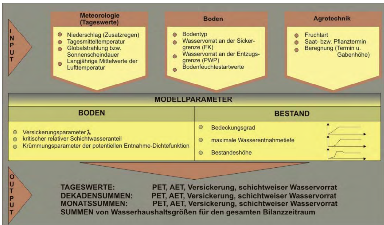
Abbildung 4: Input- und Outputparameter des Mehrschichtenbodenfeuchte- und Evapotranspirationsmodells BEREST (WENKEL et al. 2006)
