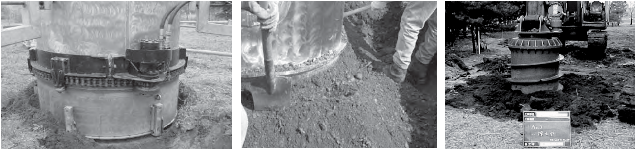
Abbildung 1: Entnahmetechniken für ungestörte Bodenmonolithen nach MEISSNER et al. 2007 a (links), TAKAMATSU et al. 2007 (rechts) und Monolithentnahme an der Forschungsstation Wagna (Mitte).
