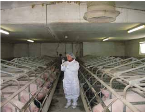
Abbildung 7: Messung des Innenpegels ( L_{A,eq} ) in einem Zuchtsauenstall
