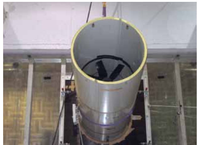
Abbildung 5: Prüfanordnung zur Erfassung der Richtwirkung (Abstrahlcharakteristik) und der Geräuschreduktion
