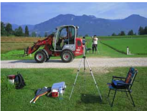
Abbildung 2: Schalltechnische Emissionserhebung der Vorbeifahrt eines Hofladers (Mikrofon beiderseits des Weges)
