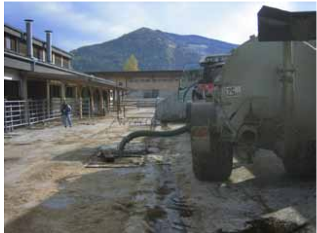
Abbildung 4: Schalltechnische Emissionserhebung einer Gülle-fassbefüllung (Mikrofon im Hintergrund)
