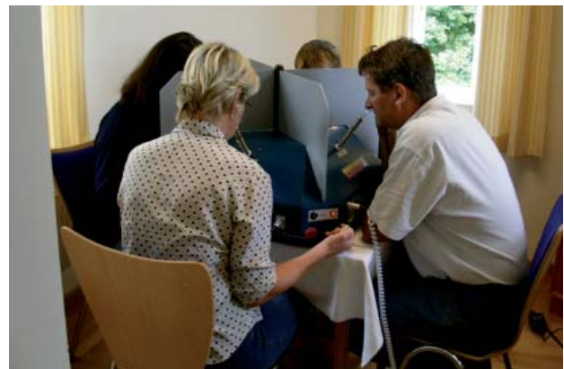
Abbildung 10: Probanden bei der Beurteilung einer Geruchsprobe am Olfaktometer TO8
