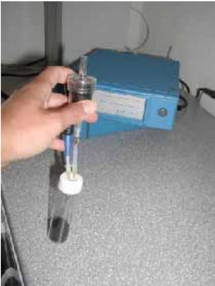
Foto 3: Durchführung einer Messung mit der elektronischen Nase PEN 2
