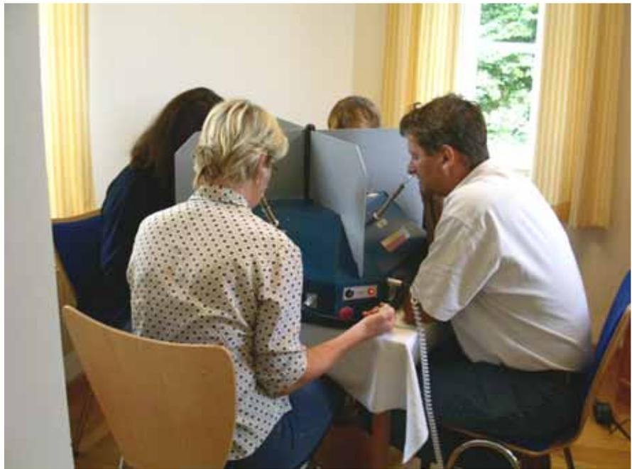
Foto 2: Bewertung von Geruchsproben durch Probanden am Olfaktometer TO 8
