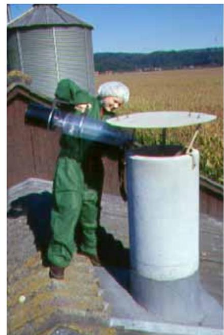
*Foto 1: Probenahme über Dach mittels Unterdruck-Probenahmegerät*
