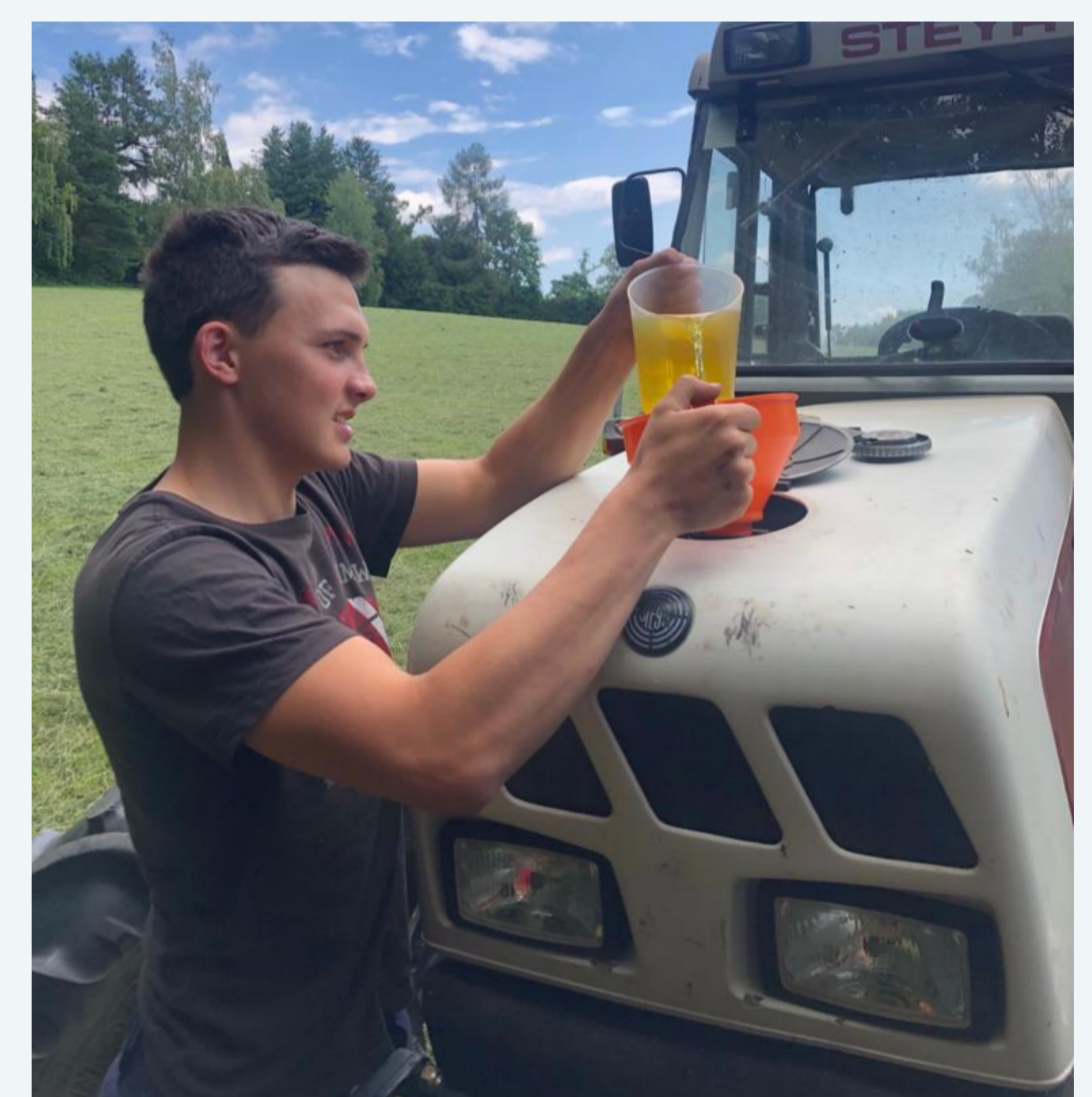
Abb.2: Messen des Kraftstoffverbrauches (Quelle: SACKL, 2020).
