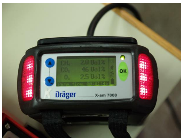
Abbildung 6: Deckel mit Kugelhahnventil und Gärgasmessung mit DRÄGER-Messgerät
