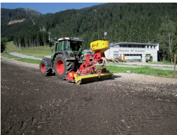
Abbildung 6: oberflächliches Einarbeiten des Komposts mittels Kreiselegge und Einsaat, Schotterrasen Zwieselalm (Gosau, August 2011, Foto Urstöger)
