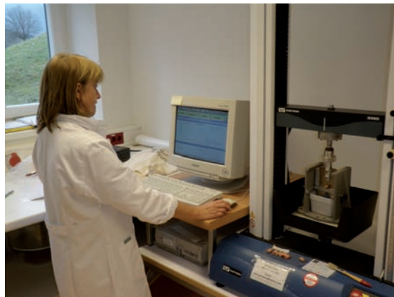
Abbildung 4.48 Messung der Scherkraft im Labor
