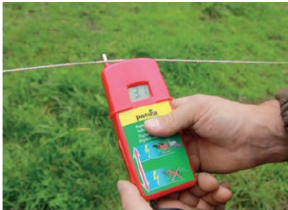
aunspannung mit simulierter Tierberührung.
