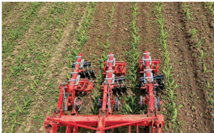
Eine weitere Möglichkeit, Unkräuter speziell in der Reihe gut zu kontrollieren, ist das leichte Anhäufeln von Erde aus dem Zwischenreihenbereich. Foto: Bio-Institut
