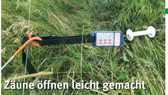
Der Weidezaunöffner "Batt-Latch" ist ein Gerät, das Rindern automatisch den Zugang zu neuen Weideflächen freigibt. Wer häufig umtreibt und oft nachsteckt, kann sich damit Zeit sparen.
