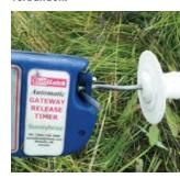
Erst wenn die Zeitschaltuhr auslöst, löst sich die Verriegelung des "Batt-Latch".
