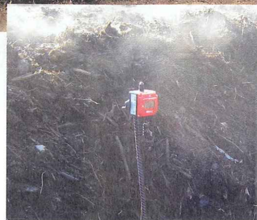
Auf 60 bis 70 °C erwärmen sich Frühjahrsmieten und Sommermieten. Bei den Wintermieten wurden hingegen anfangs nicht einmal 60 °C erreicht.
