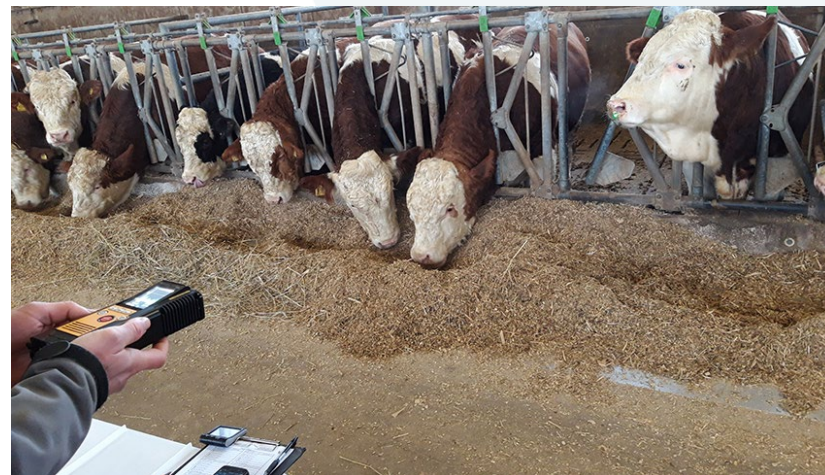
Feldmessung mit Methan Laser Mini im Versuch Zitronengras
