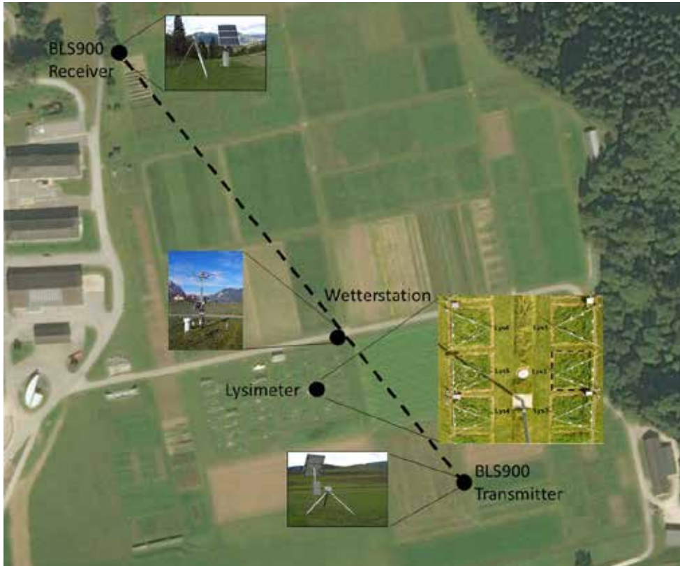
Abbildung 1: Versuchsfläche am Standort Raumberg-Gumpenstein mit Lysimeter, Szintillometer BLS900 (Receiver, Transmitter) und Wetterstation.
