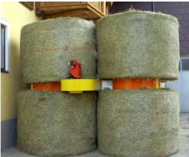
Bild 10: Kompaktanlage für 8 Ballen mit Zwischenringen (Foto MRH-Rieser)
