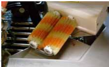
Bild: Zitzenreinigung mit Bürsten
