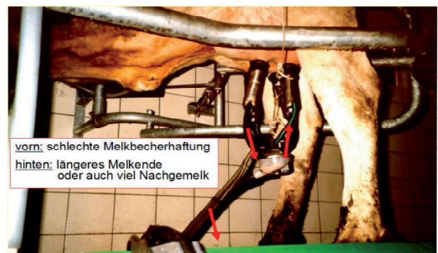
Abbildung 6: Schlauchführung und Melkzeugpositionierung nicht ausreichend
