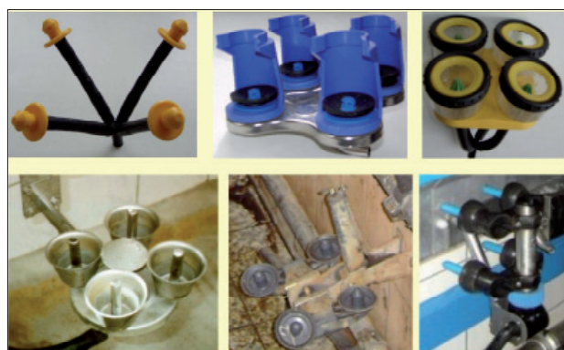
Abbildung 13: Reinigungsaufnahmen sollten Wasser in den Kopf sprühen
