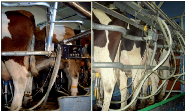
Abbildung 8: Schlauchführung von oben
