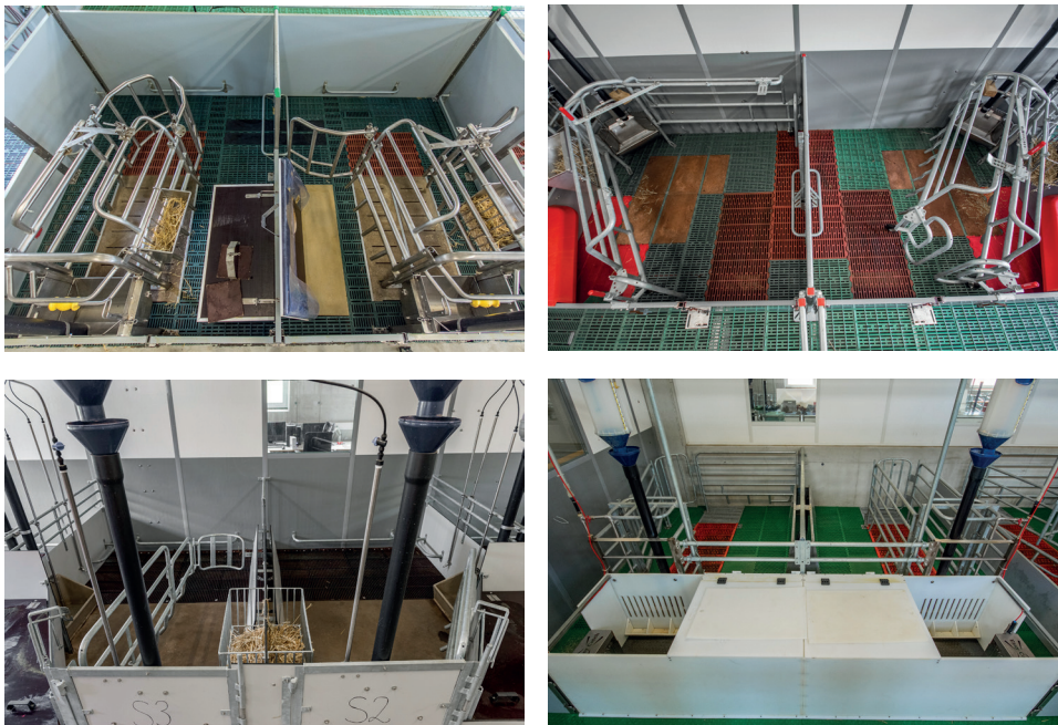
Abb. 1: Im Projekt Pro-SAU untersuchten Abferkelbuchtentypen mit temporärer Fixierungsmöglichkeit der Sau: Flügel- (links oben), Trapez- (rechts oben), SWAP- (links unten) und Pro Dromi-Bucht (rechts unten), jeweils mit geöffnetem und geschlossenem Abferkelstand (©Pro-SAU).
