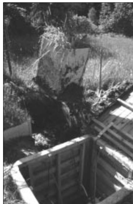
Abbildung 4: Gewinnung eines Bodenmonolithen nach dem Stechringprinzip
