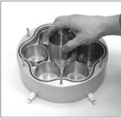
Abbildung 3: Inkubationskammer des BaPS-Messsystems
