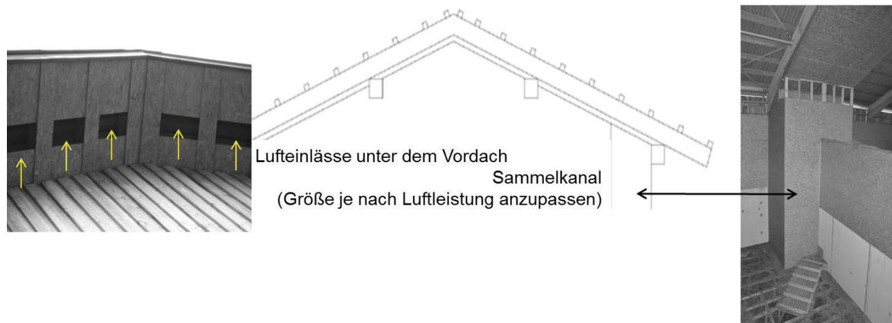
Abbildung 3: Schema einer Unterdachabsaugung bei Pfettendächern
