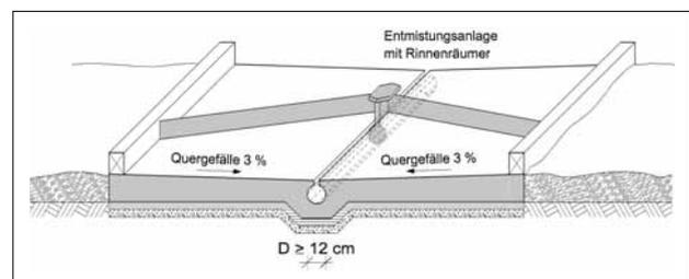
Abbildung 4: Lauffläche mit Gefälle und Harnsammelrinne ausgeführt mit Kunststoffrohr sowie Entmistungsschieber mit Rinne- und Räumermechanismen (Quelle: BUNDESAMT FÜR UMWELT und BUNDESAMT FÜR LANDWIRTSCHAFT, 2011)
