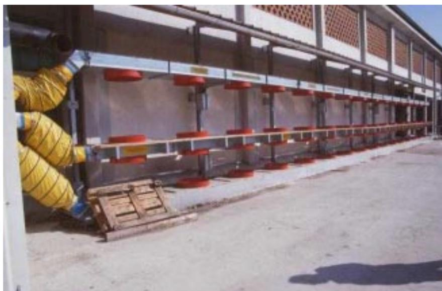
Abbildung 4: Rundballentrocknungsanlage mit doppelstöckiger Beschickungsmöglichkeit
