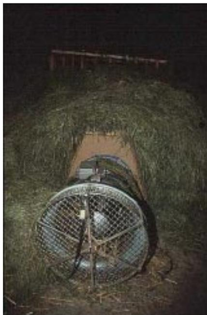
Abbildung 2: Die Giebelrostanlage ist zwar günstig in der Anschaffung, der Ventilator kann für mehrere Stöcke verwendet werden, allerdings eignet sich diese Anlage ohne zusätzliche Luftanwärmung im wesentlichen nur zum Nachtrocknen von Heu und Grummet
